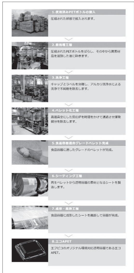
図5 使用済みPETボトルのリサイクル工程
